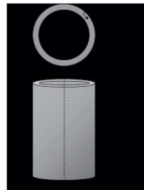
图2: 柱壳在自重作用下示意图
